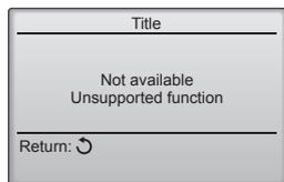
Le message à gauche s'affiche si l'utilisateur sélectionne une fonction non prise en charge par le modèle d'appareil intérieur considéré.
