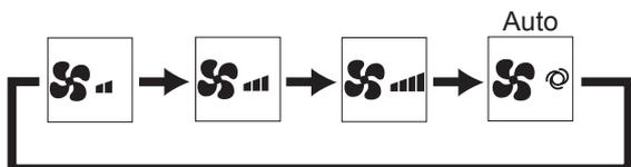
• Les vitesses de ventilation disponibles dépendent du modèle d'appareil intérieur.
