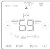
Cuando aparece la alerta de batería baja, presione ligeramente para aflojar el controlador y, luego, retírelo con cuidado del montaje de pared.
