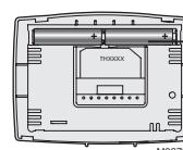
Retourner le thermostat et installer des piles alcalines AAA neuves, puis remettre le thermostat en place.
