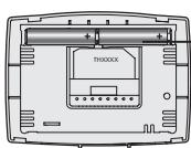
Gire el termostato e inserte baterías AAA alcalinas nuevas; luego, vuelva a instalar el termostato.
