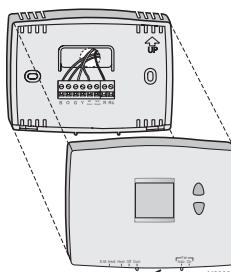
Hale de la parte inferior para quitar el termostato de la placa para pared.
