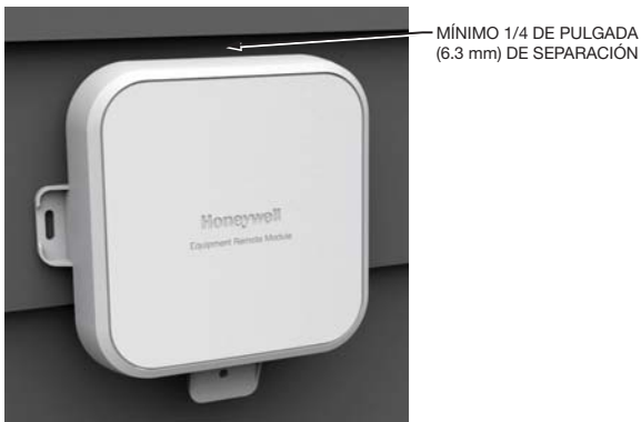
Fig. 12. Si está montado sobre paneles de revestimiento, deje espacio para que se pueda retirar la cubierta.
