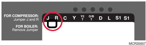
Fig. 5. Désignations des bornes montrant le cavalier entre les bornes J et R.
